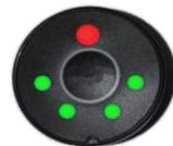
Cuando el motor alcanza una temperatura predeterminada, y estando predispuesto a funcionar con GNC, el Sistema en forma automática cambia a GNC. En este caso el LED Rojo pasa a color VERDE y el resto de la carga indica la cantidad de GNC que tiene el cilindro. Esta operación, en días de baja temperatura, podría tener una demora o hasta varios kilómetros recorridos para realizar el cambio a GNC.
